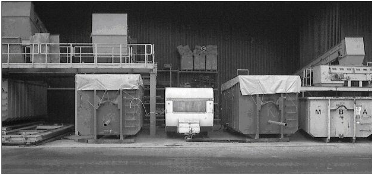
Abbildung 4 abgedichtete Versuchscontainer zur Simulation einer Nachrotte
